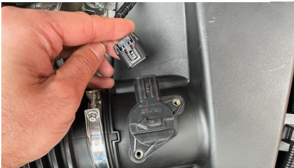
1. Remove MAF Sensor plug.
